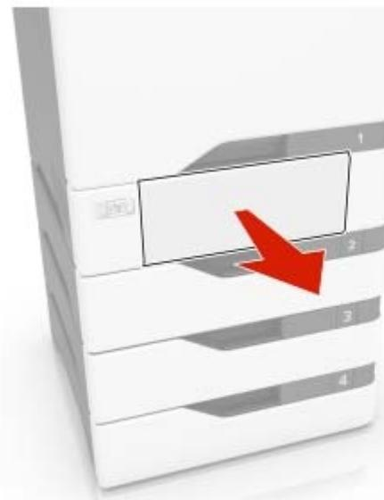
**Avertissement—Danger potentiel :** Un capteur dans le tiroir facultatif peut facilement être endommagé par l'électricité statique. Touchez une surface métallique avant de retirer le papier coincé dans le tiroir.
